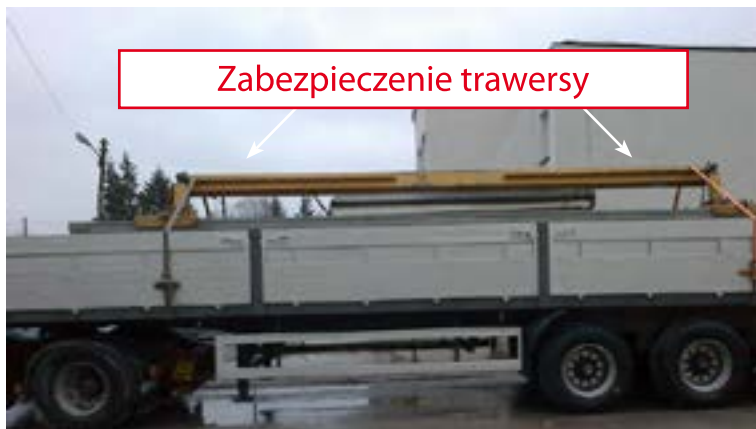
Rysunek 8. Zabezpieczenie ładunku płyt i trawersy na czas transportu
